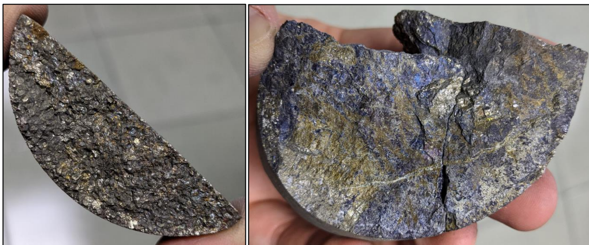
Рисунок 21 – Минералогический состав руд. Слева – медно-цинковая руда (пирит-халькопирит-сфалерит), справа – медноколчеданная руда (пирит-халькопирит-ковеллин)
